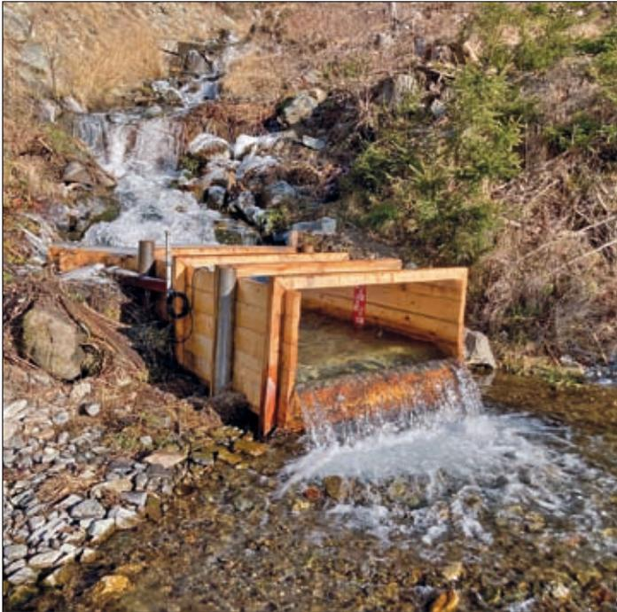
Für die Wiederverleihung des Wasserrechtes am Kleinkraftwerk Oberstufe müssen nun beim Zauchenbach (siehe Foto) und beim Marolitzbach über einen Zeitraum von zwei Jahren genaue Wassermessungen durchgeführt werden.
