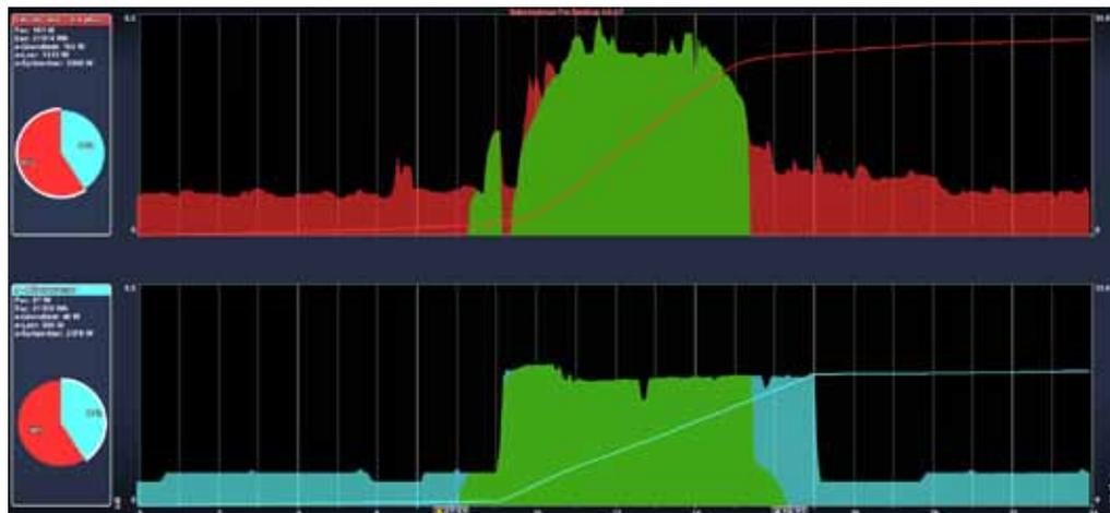
**Wärmepumpen-Leistungsaufnahme: 9-17 Uhr Wärmepumpe in Betrieb; grün => mit Photovoltaik Strom gedeckt; türkis => Strombezug von Tiwag. Photovoltaikanlage war von 07:51 bis 16:23 in Betrieb.**
