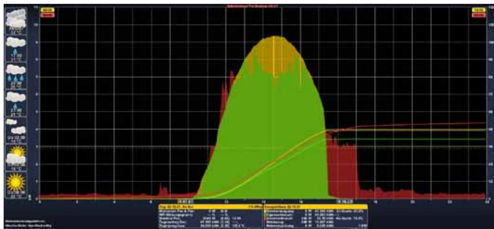
Tagesertrag vom 22.12.2021 (kürzester Tag im Jahr): PV Ertrag 47 kWh, Eigenverbrauch 41 kWh, Tagesstromverbrauch 52 kWh, Tiwag Netzbezug 11 kWh, Einspeisung 6 kWh, WP 8h in Betrieb (64 kWh).
