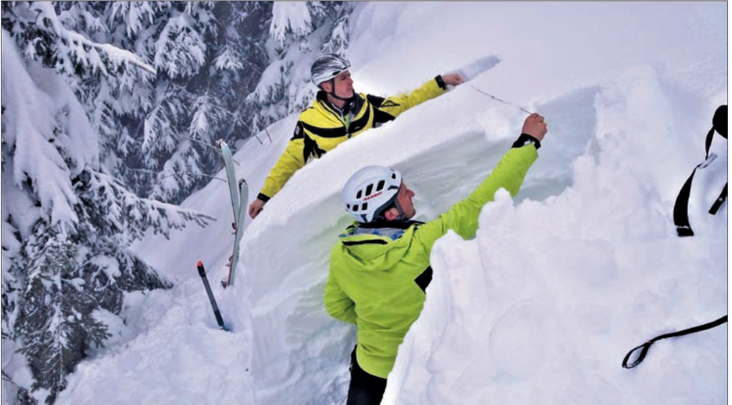
Peter Gstrein und Bernhard Kurzthaler erstellen ein Schneeprofil, um den Aufbau der Schneedecke zu analysieren und dadurch die Lawinengefahr zu beurteilen.
