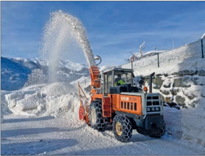
Mit einer Geschwindigkeit von 1 bis 3 km/h und einer Fahrzeugleistung von 320 PS wird der Schnee weggefräst.
